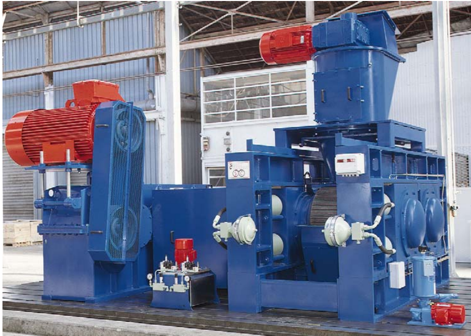
Figure 3. Compattore tipo HP1/800/400 - (Diametro rulli : 800 mm - Larghezza rulli : 400 mm - Produzione di flakes : 40 T/h).
