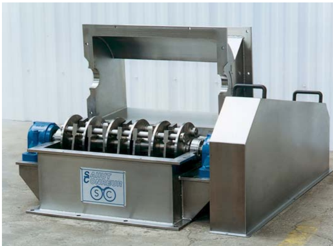
Figura 5. Mulino granulatore a martelli.
