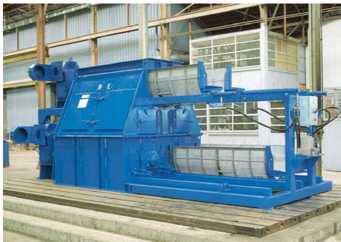
Figura 6. Granulatore a griglia a due piani.
